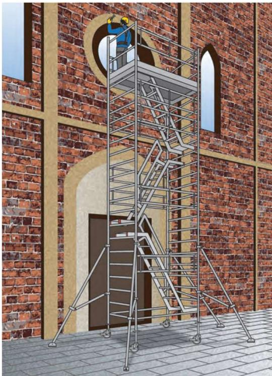
Figura 2 - Trabattello con scala a pioli inclinata
